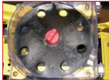
**4** Снять диск и установить выбранный диск (плоскость диска, на которой видна стрелка, по направлению к вам).
