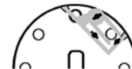
→ **РАССТОЯНИЕ ПОСЕВА:** Расстояние посева может быть отрегулировано посредством зубчатых колес, а также количества отверстий на ролике, обращаясь к таблице расстояний посева.
